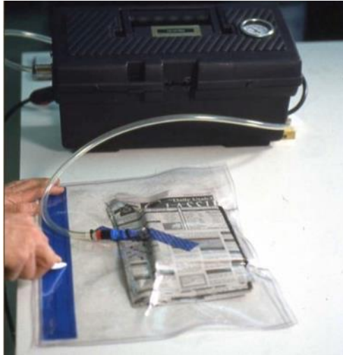
Ilustración 12. Sistema prensa de vacío con Zorbix. Fuente: Silverman et al; 2004
